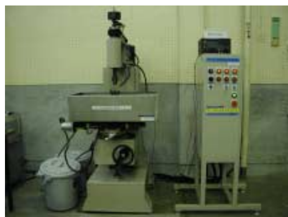
図2 電解砥粒研磨装置
