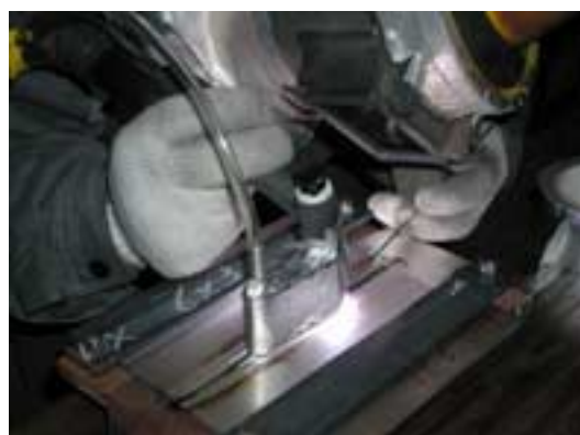
図1. TIG溶接法による突合せ継手の溶接施工
