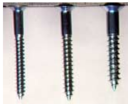
図1 供試ねじ (左側から呼び径4.5、5.1、5.8皿木ねじ)
