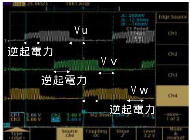
図4 3相ブラシレスモータの逆起電力
