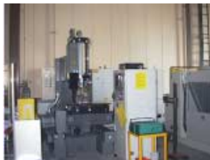
図1 炭酸ガスレーザ加工装置
