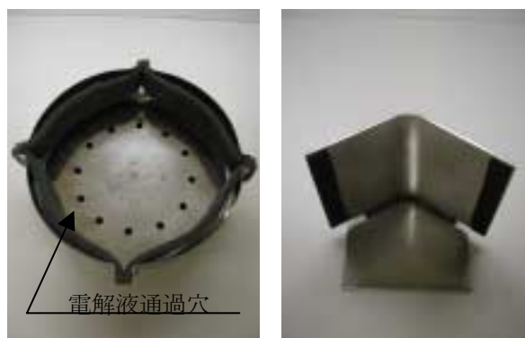
(c)外側電極工具裏面 (d)容器固定用ジグ 図5 容器固定用ジグ
