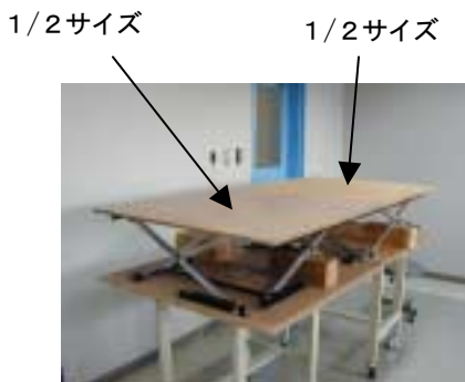
図5 2つの1/2サイズ機構部を繋いだ状態
