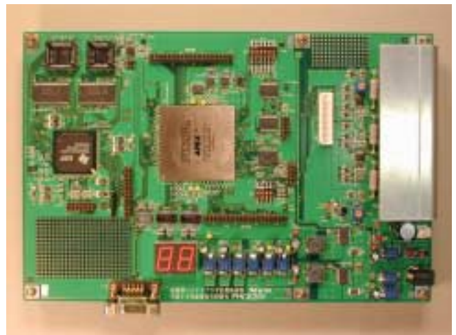
図2 モータドライブシステムFMC0201
