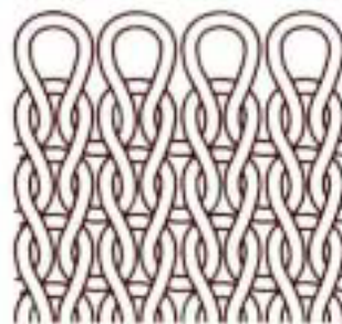
図1 編物：平（天竺）編み 特長：伸縮性、フィット性、屈曲性が良い
