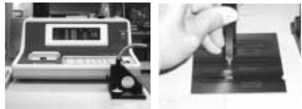
図4. 分光式色差計と測定方法
