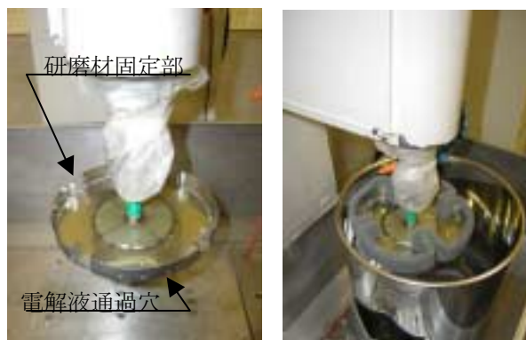
(a)電極工具 (b)研磨状況 図3 内側外側兼用直胴部用電極工具
