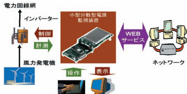
図10 小型分散型電源監視装置の機能
