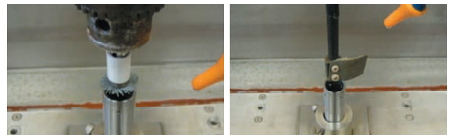
(a) ナイロンブラシ (b) ダイヤシート 図3 バリ取り材
