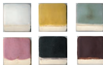
図2 開発した釉薬とその熱膨張率 (1200°Cの酸化雰囲気中で30分焼成したもの)
