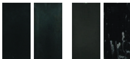
(左：遷移金属系処理あり／右：遷移金属系処理なし) 図5 塩水噴霧試験
