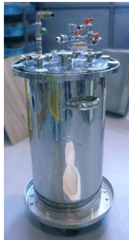
図4 泥しょうタンク
