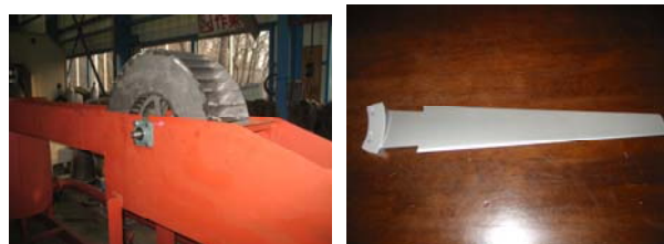
(a) マイクロ水車 (株)中川水力 (b) 改良型ブレード (株)ジーエスピー
