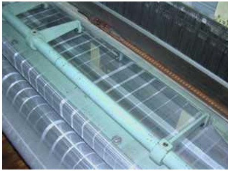
図4 量産型シルク意匠糸の試織 使用筈:110羽/鯨寸、組織:模写組織 素材 :経 スパークナイロン16(d) 偉 生糸24(中)
