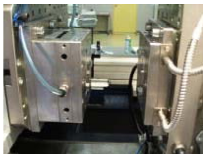
図6 作製した金型
