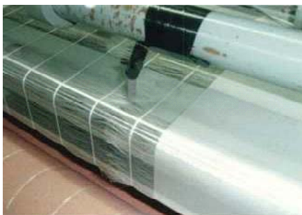
図4 織機上にカッターを配置し裁断している様子
