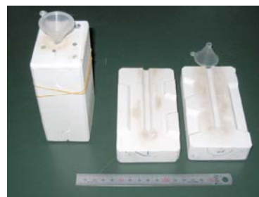
図2 成形に用いた石膏型
