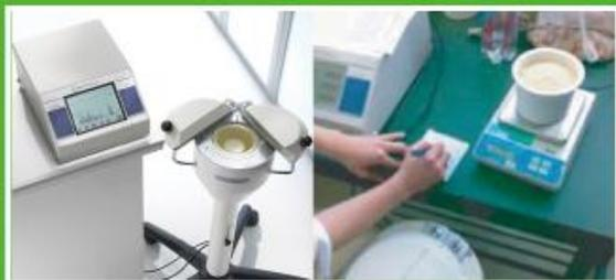
いわき市で導入したNaIシンチレーター検出器を活用し、福島県の検査と併せ、出荷前の安全確認モニタリング、安全継続確認モニタリングを実施します。暫定規制値を超える可能性がある場合には、関係機関(市、県いわき農林事務所、JAいわき市、JAいわき中部)に早急
