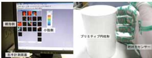
図6、圧力分布測定システム
