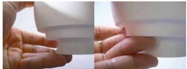
図16、改善したポイントを確認するための石膏による試作品
