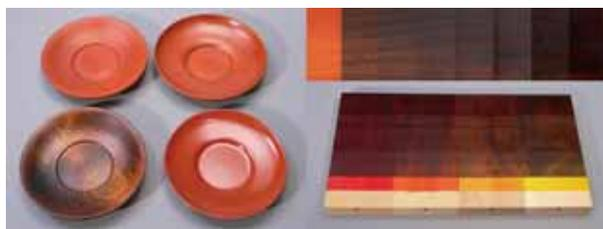
図17、左：塗り仕上げサンプル、右：工程サンプル
