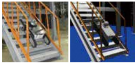
(左)ロボットが階段を走行する実機試験の様子 (右)シミュレーションによる再現
