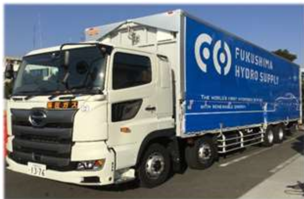
H29: 移動式水素ステーション (ふくしま hidro サプライ株)
