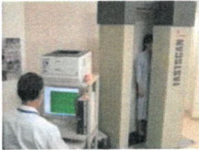
立位式ホールボディカウンタでの内部被ばく検査の様子の写真（測定時間約2分） 出典：郡山市ホームページ 内部被ばくの健康管理
