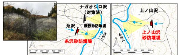
②図4.2 土石流危険渓流に計画する砂防堰堤
