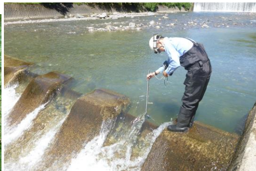
小水力ポテンシャル調査 （左）落差計測 （右）流量測定
