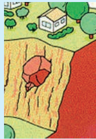
②斜面に浮き石
