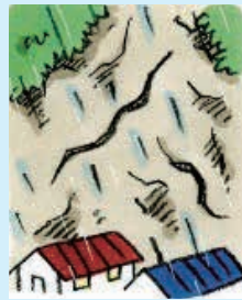
①斜面に亀裂
