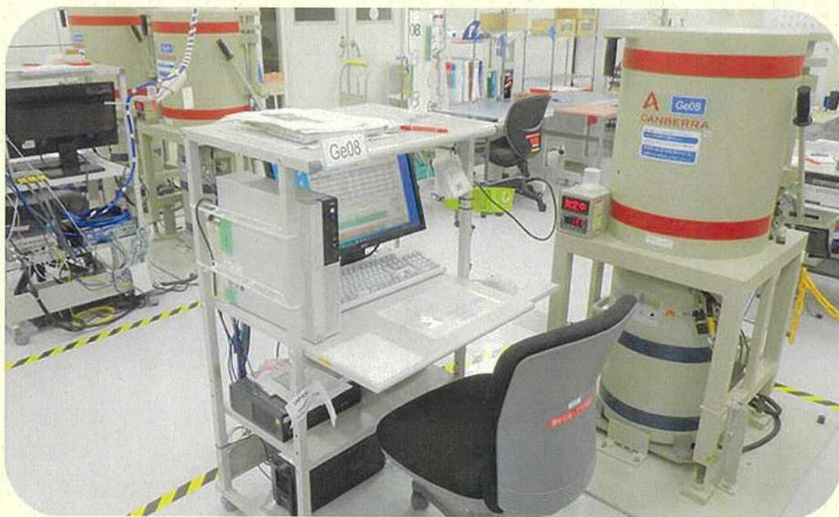
使用「鍺半導體探測器」詳細檢測
