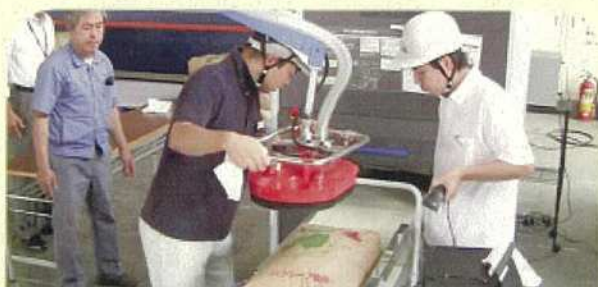
使用「鍺半導體探測器」詳細檢測
